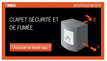
Tant que le clapet de retour de flamme n'a pas été tiré et que le clapet des fumées n'a pas été fermé, l'appareil ne peut être mis en service.
